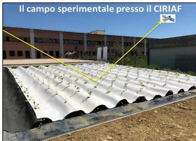
**Fig. 11.** Membrana ad elevato albedo per la Pacciamatura di ortaggi con sub-irrigazione e raccolta di acque piovane. La quantità di radiazione solare riflessa fuori dall'atmosfera è misurata e contabilizzata da satellite.
